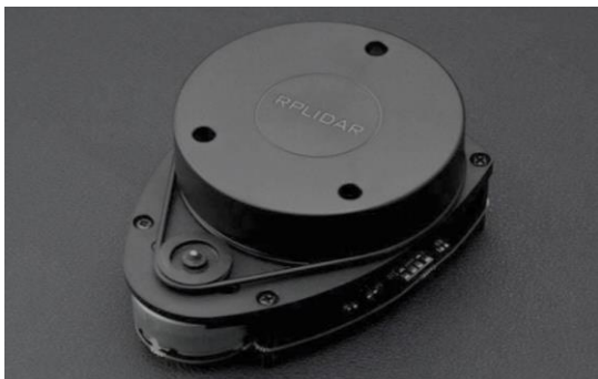
Gambar 2. Sensor Rplidar A1M8 (Sumber: penulis, 2022)
