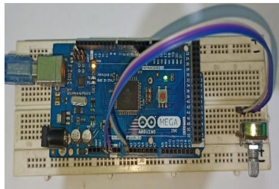
Gambar Error! No text of specified style in document. Rangkaian pengujian ADC
