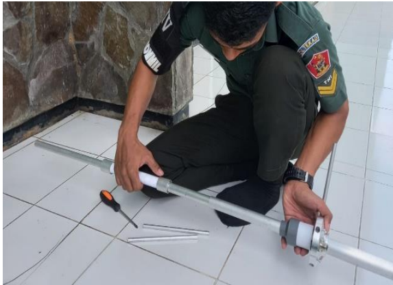
Gambar 8. Penyambungan bagian-bagian antena.
