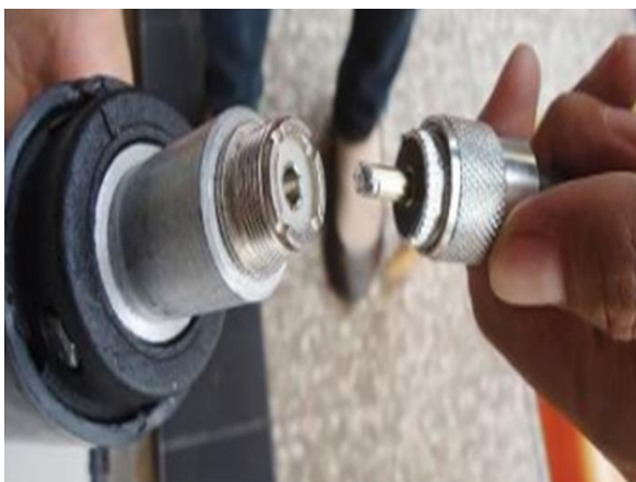
Gambar 9. Penyambungan Konektor ke Loading impedansi.
