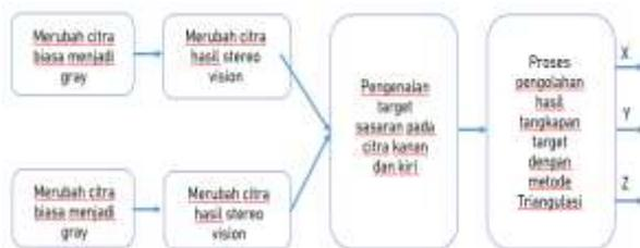
Gambar 5 diagram perhitungan posisi target
