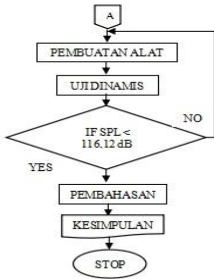
Gambar 1. Diagram alir rancang bangun silencer dengan tipe omega baffle.
