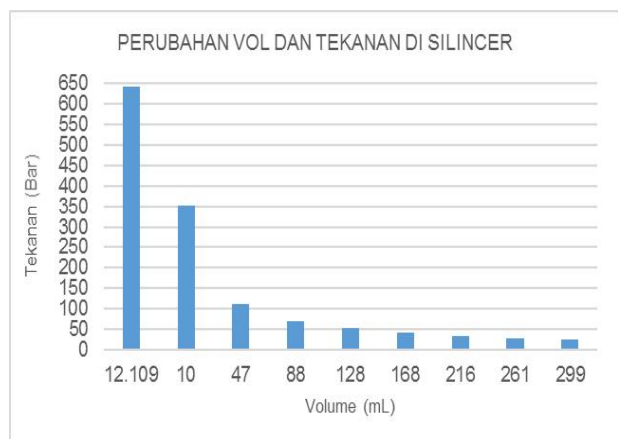
Gambar 15. Diagram Perubahan Volume dan Tekanan Gas Pada Silencer
