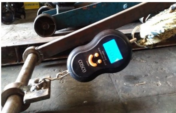
Gambar 4. Pengukuran Beban Pada Lesan Tembak Tempur Cepat. (Sumber : Peneliti)
