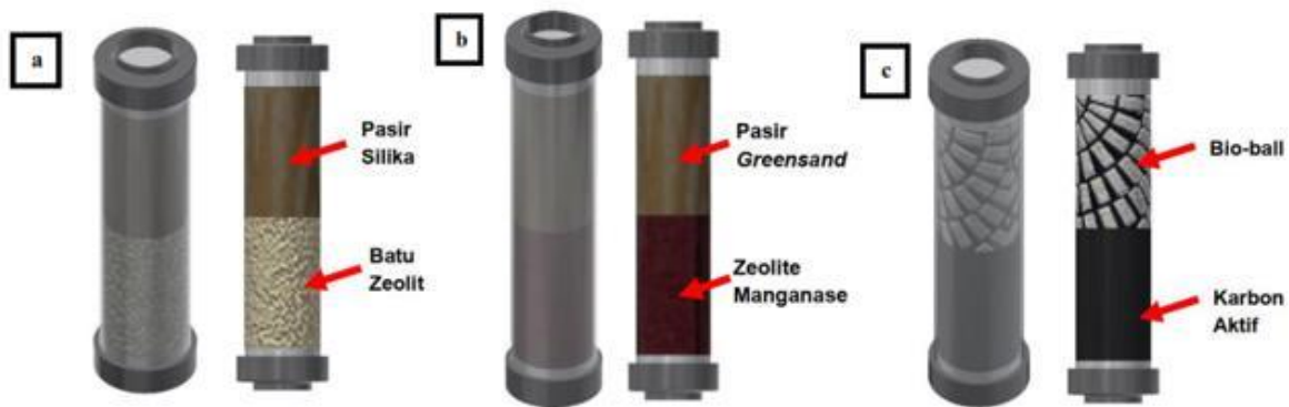
Gambar 5. Desain tata letak bahan media filter tahap a) ke-1, b) ke-2 dan c) ke-3 (Yaqin et al., 2021)
