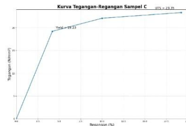
Gambar 5. Kurva regangan tegangan sampel C
