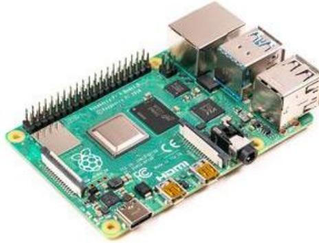
Gambar 3. Bentuk dari Raspberry Pi 4
