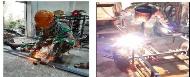
**Gambar 2.5** Proses Pemotongan Dan Pembuatan Rangka Robot Tempur
