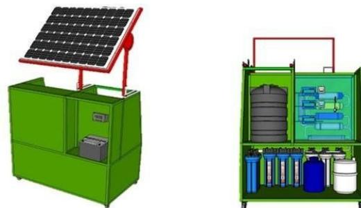
Gambar 1. Desain Alat Desalinasi Air dengan Tenaga *Solar Cell*.
