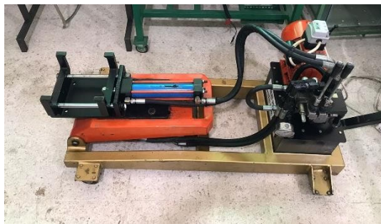
Gambar 3. Alat Pelepas dan Pemasang Rantai Tank AMX-13
