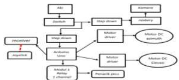
Gambar 2. Blok Rangkaian Kendali RCWS Sistem Kelistrikan TGR-25
