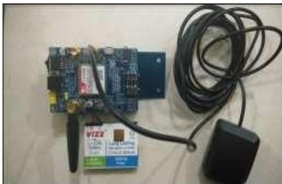
Gambar 3. Bentuk Modul SIM808 support GPS
