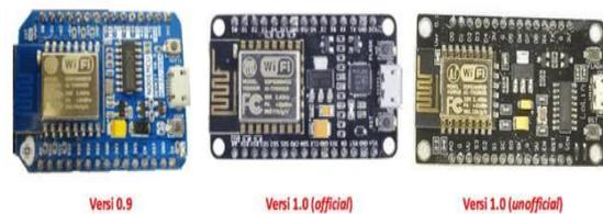
Gambar 6. Bentuk NodeMCU ESP8266
